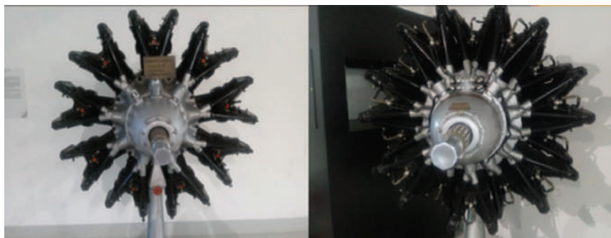
Слика 6: Авионски звездасти мотори, 9 и 2x7 цилиндара, Индустрије мотора Раковица
